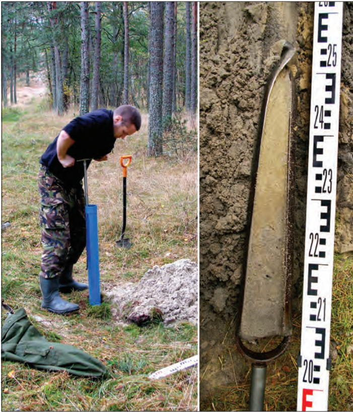
8 pav. Gręžimas rankiniu grąžtu plastikiniame vamzdyje. 2,25 m gylyje pilkšvą smėlį su organika ir angliukais, t.y. archeologinį Nidos 1 gyvenvietės sluoksnį, pakeičia šviesus smėlis be radinių. G. Piličiausko nuotr.
