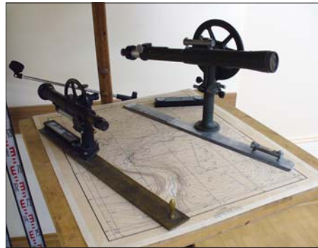
8a–b pav. Menzula – iki XX a. vidurio lauke naudotas braižymo stalelis vietovės planui ar žemėlapiui sudaryti; planšetė (kvadratinė lenta) – menzulos dalis, ant kurios tvirtinamas braižomasis popierius (edukacinė ekspozicija Aerogeodezijos ir kartografijos instituto salėje) (2009 m.). V. Vaitkevičiaus nuotr.
