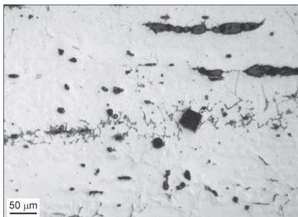
23 pav. Ietigalio plunksnos skerspjūvio (bandinys 1410-I/2) mikrostruktūra. Nuotraukoje matyti sluoksniuota struktūra ir šlako intarpai, taip pat mikrokietumo matavimo pėdsakas (tamsus kvadratis). Optinis mikroskopas, bandinys išdintas \text{HNO}_3 tirpalu. A. Selskienės nuotr.
