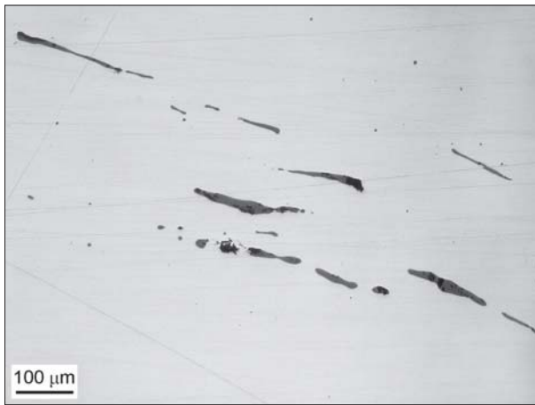
11 pav. Metalurginių šlakų intarpai kirvio 1405-K ašmenyse. Optinis mikroskopas, bandinys neryškintas. A. Selskienės nuotr.
