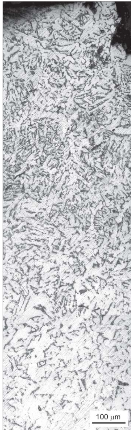
27 pav. Ietigalio plunksnos (band. 1414-I/3) įanglinto sluoksnio mikrostruktūra. Nuotraukos viršuje – bandinio pakraštys. Optinis mikroskopas, bandinys išdintas \text{HNO}_3 tirpalu. A. Selskienės nuotr.
