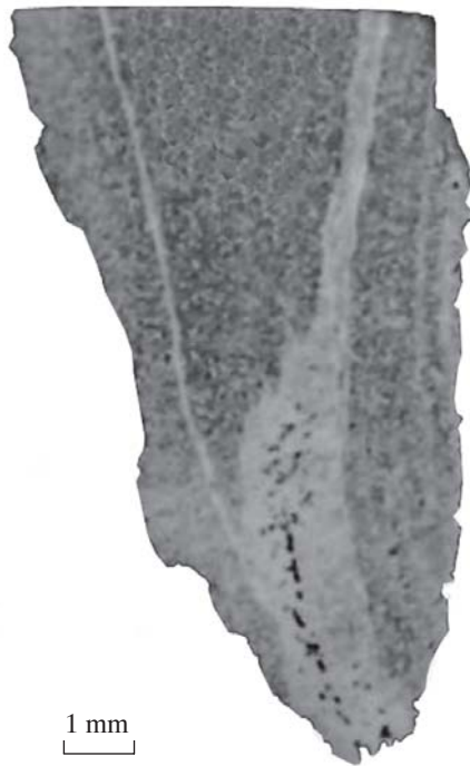
17 pav. Kirvio 1357-K ašmenų bandinio sandara: suvirinimo siūlės (šviesios), jungiančios centrinę ir išorinę kirvio dalis, matyti šlakų virtinė (tamsūs). Bandinys poliruotas ir išdintas \text{HNO}_3 tirpalu. A. Selskienės nuotr.
