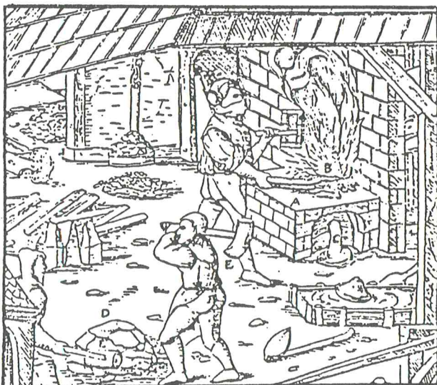
1 p a v. Viduramžių rudnia. Raide A pažymėta rudnė, su kaupu prikrauta rūdos ir medžio anglių B. Per specialią angą iš rudnės teka šlakas C. Du kalviai mediniais plaktais E apdaužo šviežiai išlydytą kritę D (G. Agrikolos knygos (1556 m.) iliustracijos fragmentas)
